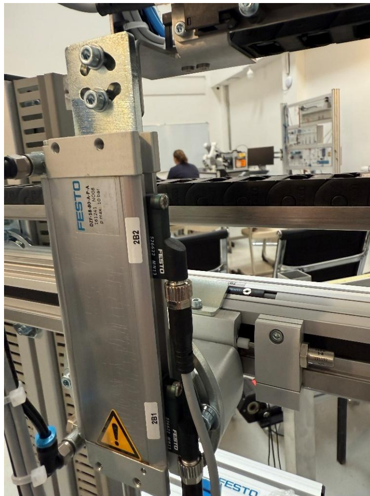
Figura 5. Cilindër pneumatike Festo me sensorë magnetikë të integruar për detektimin e pozicionit.
